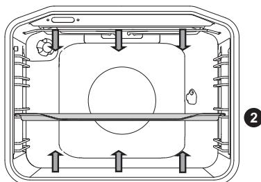
Topné články ve spodní části a ve stropě uvnitř trubky budou rovnoměrně vyzařovat teplo do vnitřku trubky.
