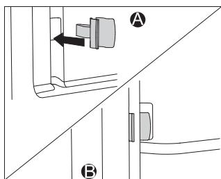
Při instalaci plně vysouvacích vodítek s katalytickými vložkami, vložte jeden konec dodané upínadel zámky do otvoru v dolní části vnitřku trouby a vložte druhý konec úchytné zámky do vodítka. Účelem upínadel zámků je držet vodítka pevně na místě.
