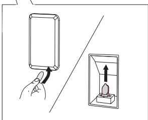
Pomocí plochého šroubováku uvolněte kryt žárovky a odstraňte ho. Vyjměte žárovku.
