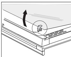
**3** Chcete-li odstranit třetí skleněnou tabuli (pouze u některých modelů), nadzvedněte ji a odstraňte. Také odstraňte gumové těsnění na skleněné tabuli.
