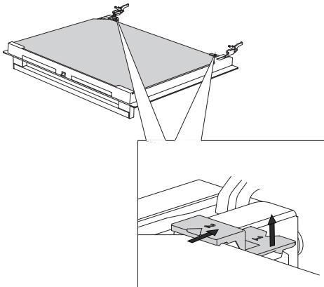
**1** Mírně nadzvedněte držáky na levé straně dveří (označení 1 na držáku) a vytáhněte je směrem od skleněné tabule (označení 2 na držáku).
